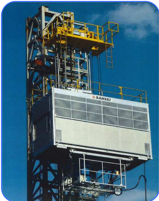
■工事用エレベーター（積載3000 k g）
