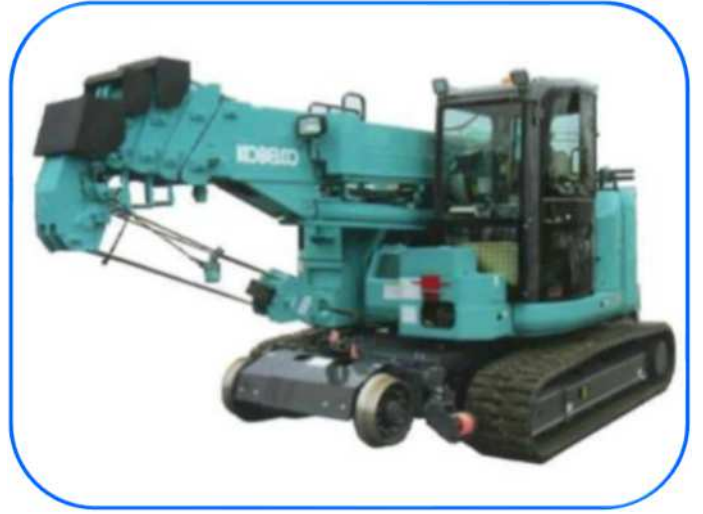
■ 4.9 t クローラークレーン
